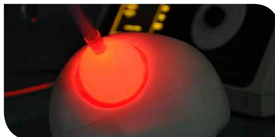
Dispositif d'illumination peropératoire utilisé dans le cadre des essais cliniques (modélisation numérique – essai sur simulateur)
